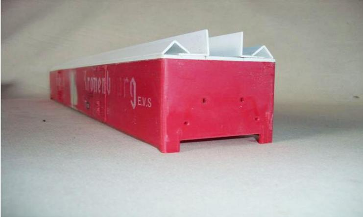
Auf dem senkrechten Teile des Winkelprofils werden Stütz- Leisten geklebt an beide Seiten als Stützung von der Dachdeckung.
