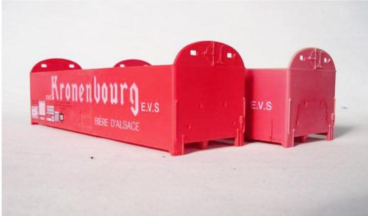
Von beiden Gehäusen wird eine Stirnseite völlig entfernt mit genau 12 mm Seitenwand
