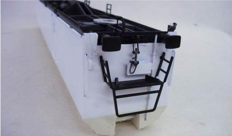
Die Drehgestelle werden ans Gehäuse angeschraubt.
