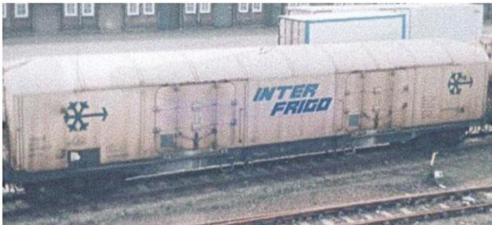
Die ausgewählte Baureihe vom dieser ersten Bau los für das Umbau Projekt stammt aus Frankreich Epoche 4, war eingereiht bei INTERFRIGO als Laehs und ausgestattet für Trocken Eis.
